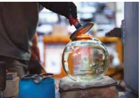
へそはバーナーで溶かしながら押し付ける
